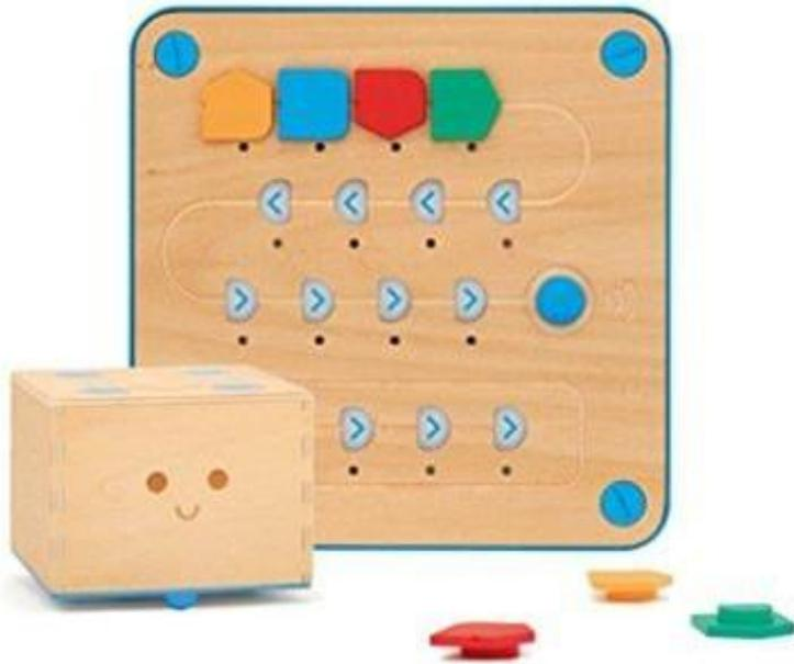
Cubetto si muove su ruote e si controlla via Bluetooth tramite una tavoletta forata in cui inserire 16 tasselli, di 4 colori diversi, a ciascuno dei quali corrisponde un comportamento diverso del robot.
