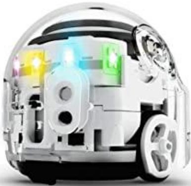
Ozobot è un robot in grado di muoversi e reagire su superfici fisiche e digitali, seguendo percorsi colorati. Questo piccolo robot sa riconoscere oltre 1000 istruzioni ed è programmabile sia in digitale con l'app dedicata, sia attraverso l'uso di pennarelli colorati.
